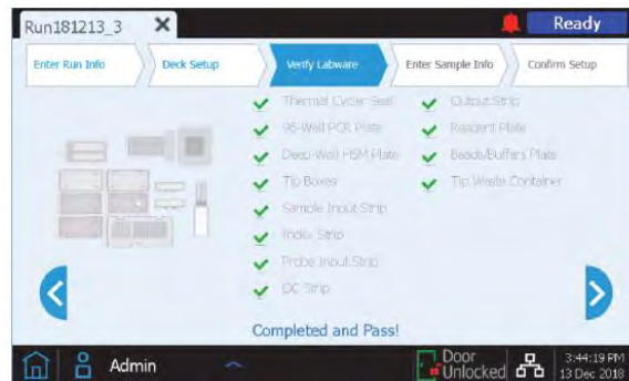
Figura 17. Pantalla Verify Labware del equipo Magnis NGS Prep, tras una verificación correcta del material
